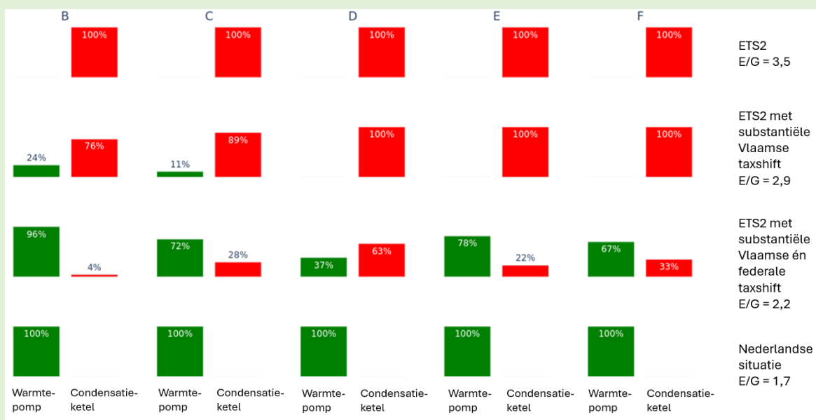
Figuur. Aandeel van woningen waar een warmtepomp resp. gascondensatieketel de laagste TCO heeft per EPC-label en per prijsverhouding tussen elektriciteit en gas (E/G) bij een gemiddelde premie van 3.000 euro (VITO, 2025)
